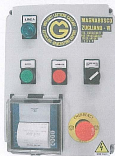
Pannello di comando con registrazione della pastorizzazione. Electrical control panel with pasteurizing recorder.
