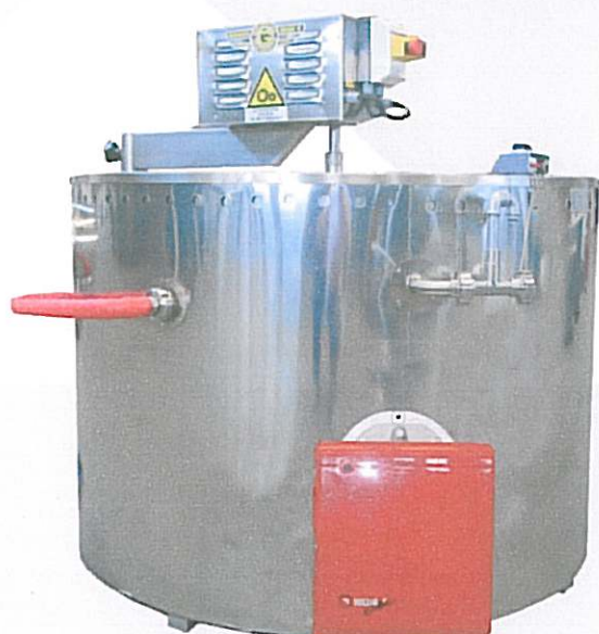
CB a gasolio con agitatore mobile, con isolamento. CB gasoil heated, with mobile mixer and insulation.
